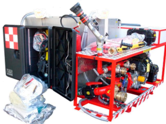
pompa senza tener conto della criticità di utilizzo. Su richiesta Miscelatore Lineare 0,5%-6% collegato al serbatoio schiumogeno. Seconda utenza per aspirazione liquido schiumogeno dall'esterno tramite tubo pescante.
