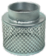
VS4078 FILTRO FILETTATO IN ACCIAIO Filtro con zincatura elettrolitica con manicotto filettato interno su richiesta acciaio inox da 2" a 6"
